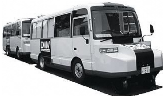
※ DMV DMVは、Dual Mode Vehicle（デュアル・モード・ビークル）の略 道路とレールの両方を走行できる車両のこと。
